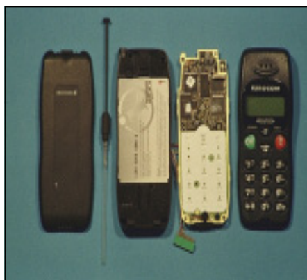
Vue éclatée d'un téléphone portable - Source : CNRS
